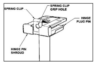
Disengage Hinge Pin
